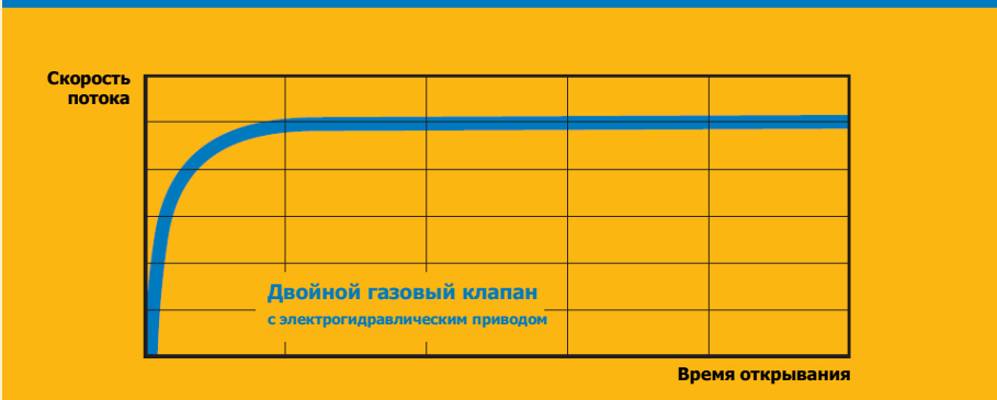
Электрогидравлический привод: плавный запуск горелки благодаря плавной подаче газа
